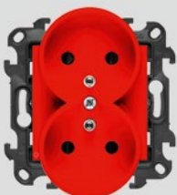
NGZ2MCZ.01/AB22 Gniazdo wtyczkowe podwójne z uziemieniem i przesłonami torów prądowych (moduł) 16 A, 250 V~, szybkozłączka. Kolor czerwony. ■ Antybakteryjne.
