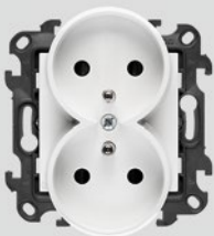
NGZ2MCZ.01/AB11 Gniazdo wtyczkowe podwójne z uziemieniem i przesłonami torów prądowych (moduł) 16 A, 250 V~, szybkozłączka. Kolor biały. ■ Antybakteryjne.
